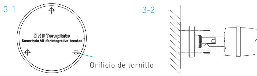
3. Pase los cables de la cámara a través de la base de montaje y conéctelos a través de la apertura lateral.
